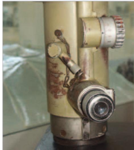
*Einblicköffnung eines Bunkersehrohrs des Westwalls zum Beobachten der Umgebung aus dem Bunker heraus.*
