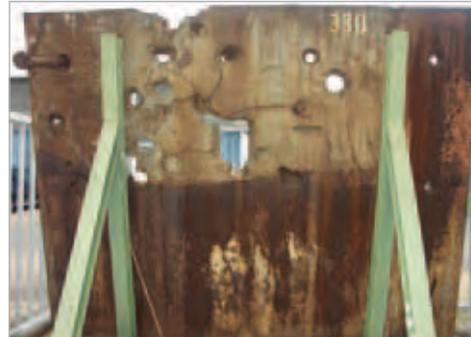
*Völlig zerschossene Schartenplatte eines Westwallbunkers. Der einfache Walzstahl hatte modernen Geschützen nichts mehr entgegen zu setzen.*
